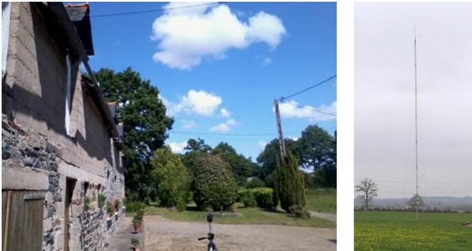
**Figure 8- Mesure acoustique et mât de mesure du vent (source Gamba Acoustique)**
