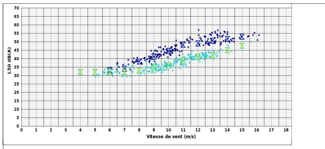
**Figure 9 - Corrélations entre bruit mesuré (LA50, 10 min) et vitesses de vent moyenne 10 min (source Gamba Acoustique)**
